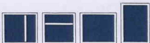
Derartige Fensterformen und -formate sollten in Rendsburg nicht verwendet werden.
