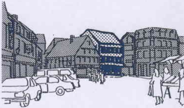
So nicht! Keine abgeschlossene Einheit: Die Fassade läuft auseinander, der Zusammenhalt fehlt.
