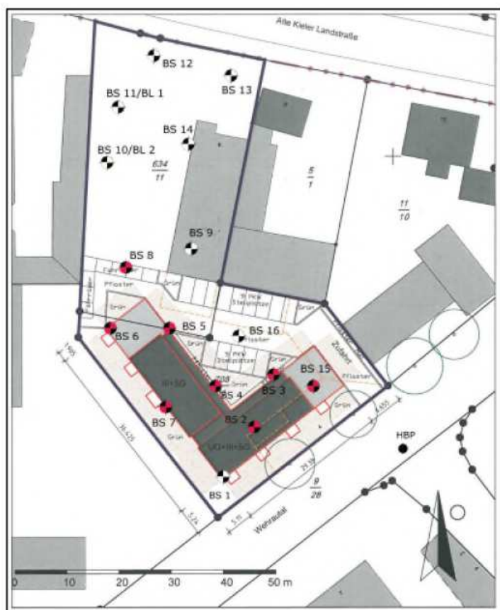
Abb. 1: Lage der Kleinrammbohrungen mit Proben in MP 1 (rot/schwarz), M 1:1.000
